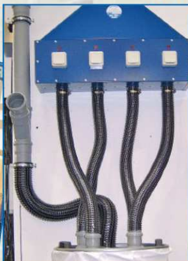
Diese Sauganlage wird in der Regel in der Nähe des Taubenschlages installiert, am besten dort, wo der Abfall am einfachsten entnommen werden kann. Eine solche Anlage arbeitet seit Jahren auch in der Taubenklinik des Verbandes.
